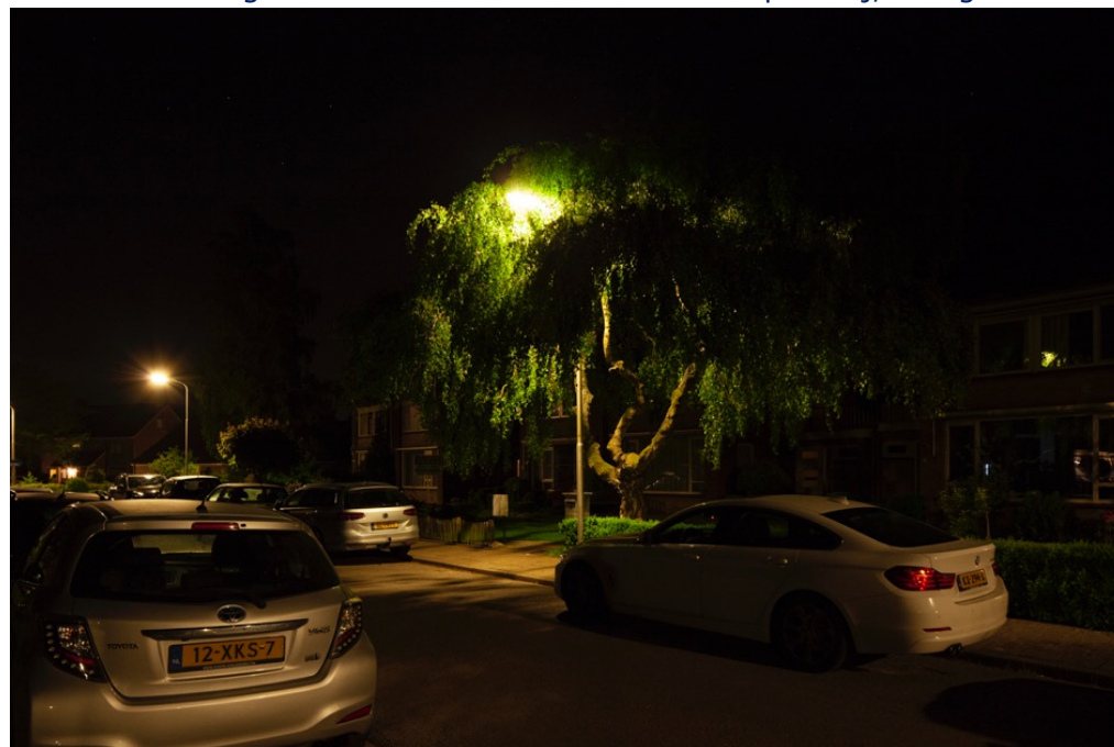
Foto: Buitenkamp in Epse. Lantaarnpaal staat in de boom en geeft niet voldoende licht meer op de weg daardoor. Door goede, vroegtijdige afstemming kan dit voorkomen worden.
