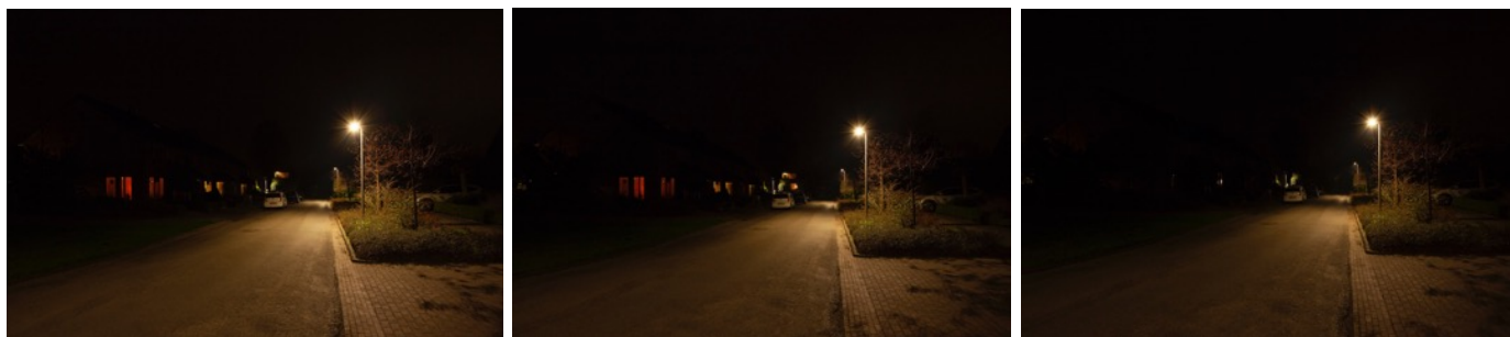
Foto: Reuvekamp in Gorssel. Foto links volle sterkte, midden op 70% en rechts op 50%.
